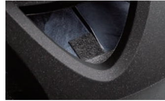
ウーファー振動板裏 制振素材
