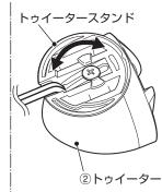
角度を調整しネジを締める
