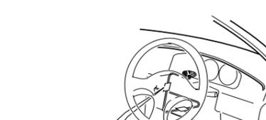
付属のクランパーなどで要所を固定しながら、運転操作に支障がないようにマイクコードを引き回します。
