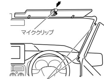
付属のクランパーなどで要所を固定しながら、運転操作に支障がないようにマイクコードを引き回します。
