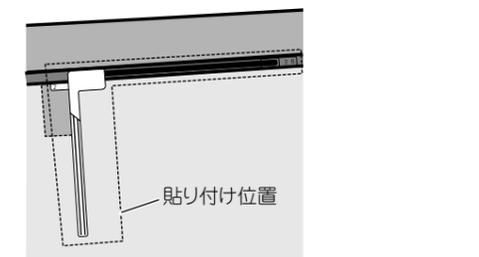
注：十分に汚れ、油膜、水分を拭きとってから貼り付けてください。また、真冬に車内が温かくなると、窓ガラスが結露しますので、十分に乾燥させてからフィルムを貼り付けてください。
