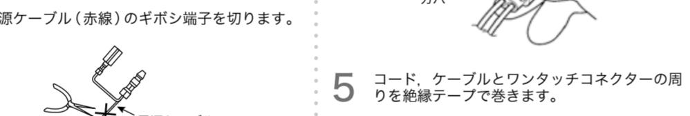
2 車体側のプラス電源コード(ACCライン)をガイド溝に入れます。電源ケーブル(赤線)をワンタッチコネクターケーブルの分岐穴に通します。
