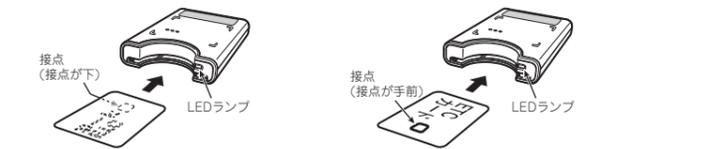
2 「ピー コード03 カードを確認してください」と音声案内が聞こえたら、ETCカードを取出します。(①) ETCカードの接点を下\*1または手前\*2にしたまま、再度2秒以内にカード挿入口の奥まで押し込みます。(②)
