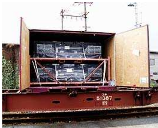
2段積みによる12フィート鉄道コンテナの積載率向上事例
