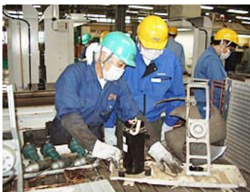
ハイパーサイクルシステムズでの家電製品解体シーン（製作所の設計者が、実際の家電製品解体ラインで、ベテランから指導を受けているところ。環境適合設計を修得する研修の一環）
