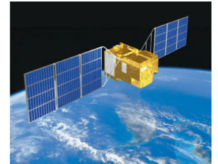
温室効果ガス観測技術衛星（GOSAT）は、宇宙から温室効果ガスの濃度分布を観測する人工衛星です。当社はこの衛星の製造にプライムメーカーとして参画しています。
