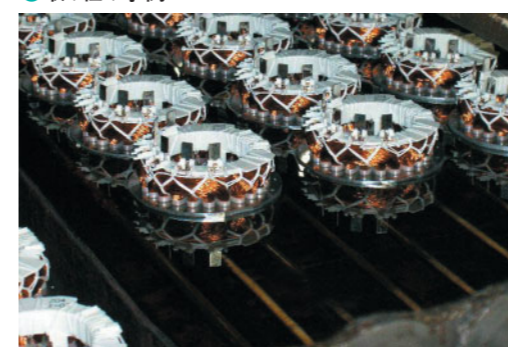
▲モーターの銅線コイルに絶縁用のワニスを塗り込む作業。この工程で鉛フリーを実現しました。
