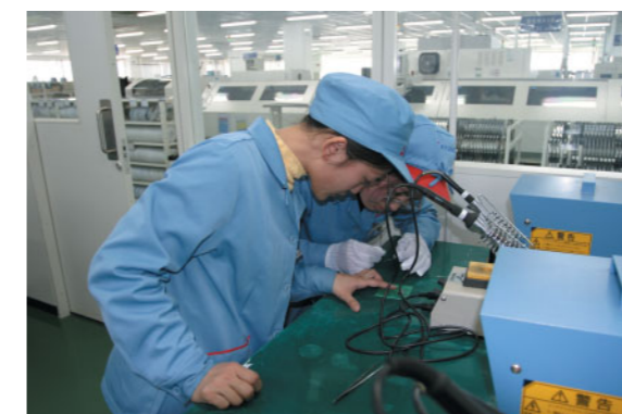
▲MDIでは基板に使うのはんだの鉛フリー化を進めている。鉛フリーのはんだ付けには技術が必要なため、熟練者は後輩の指導にもあたる。
