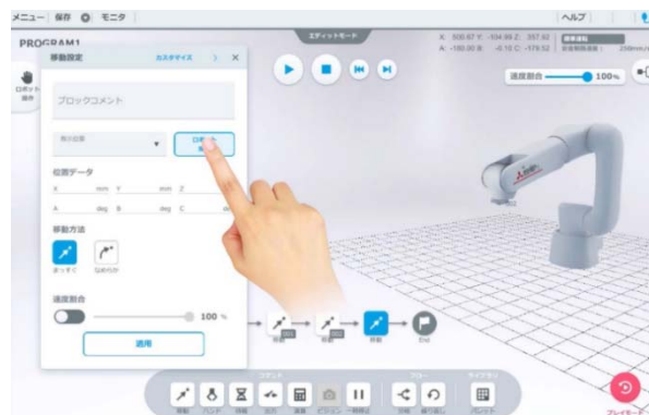
プログラム作成ツール (エンジニアリングソフトウェア「RT VisualBox」)
