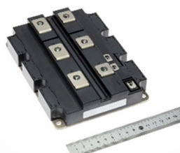
140mm x 190mm 絶縁耐圧 6kV rms タイプ (HVIGBT)
