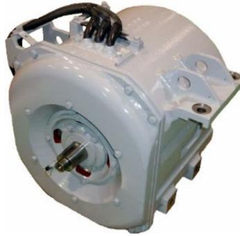
開発した鉄道用主電動機の外観
