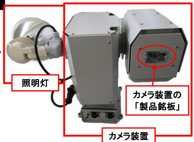
図2 カメラ装置の構成・外観例(背面)
